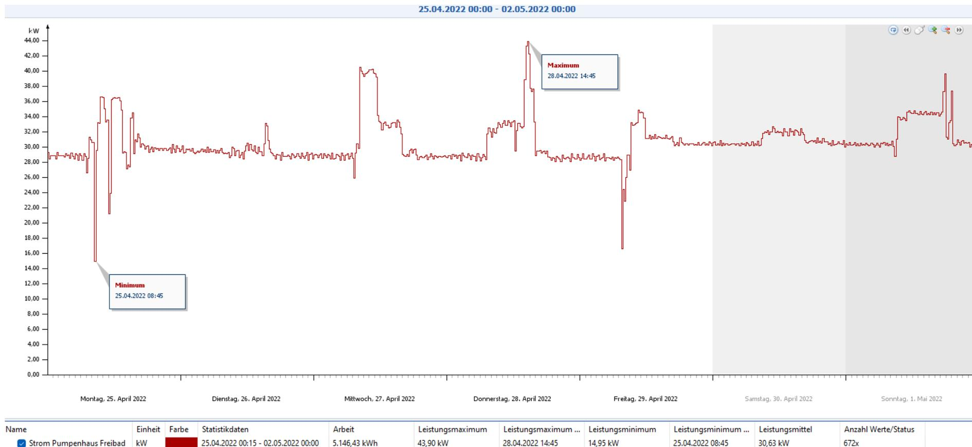
Abbildung 29: Lastganganalyse Strombezug Woche Leistungsspitze
