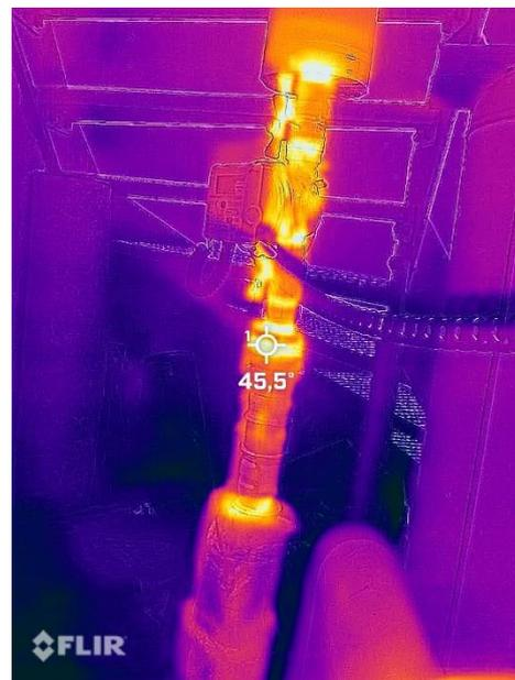
Abb. Leitungsabschnitt ohne Isolierung (Foto/ Thermografieaufnahme)
